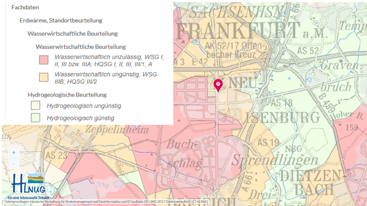
Abbildung 33 - Hydrologische Standortbeurteilung hinsichtlich Erdwärmenutzung
